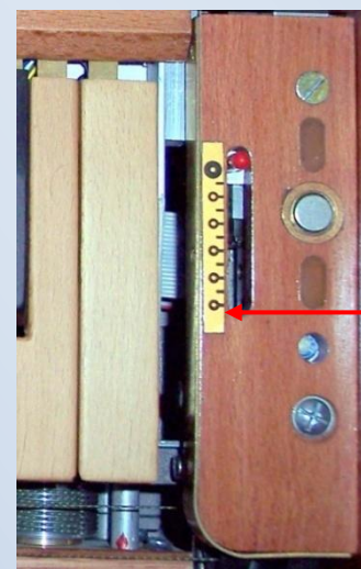
Lever de commutation des registres, grave et aigu des jeux au clavier et à la bague
