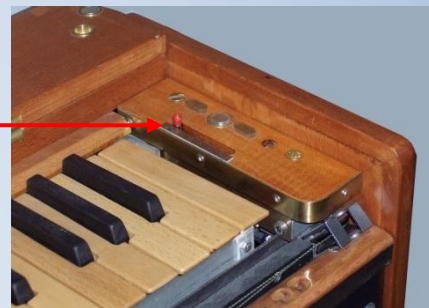
Leviers de blocage et de réglage de la dureté du clavier
