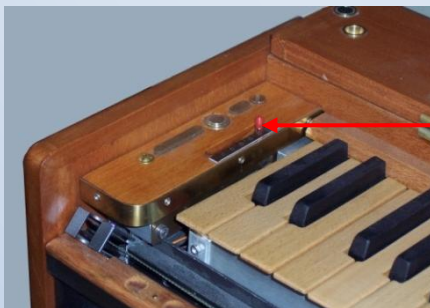
Leviers de blocage et de réglage de la dureté du clavier
