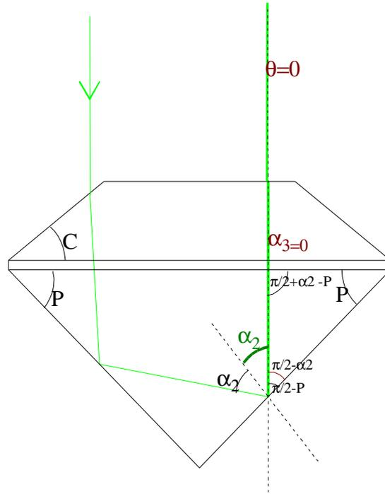
Ceci permet de calculer une correspondance entre P et C pour que les rayons entrant par la couronne ressortent perpendiculairement par la table :
